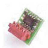
N BM1000 rozšiřující paměťový modul pro zvýšení kapacity MORX
